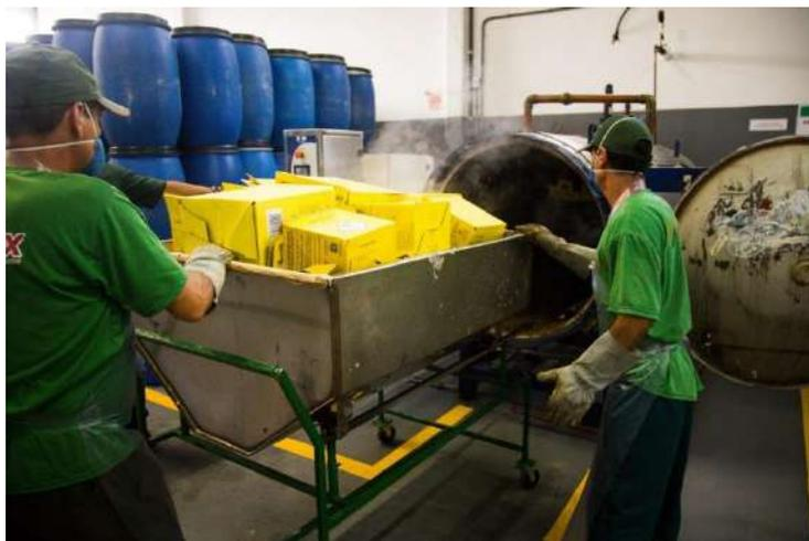
Foto 5 - Processo de desinfecção do RSS com autoclave
